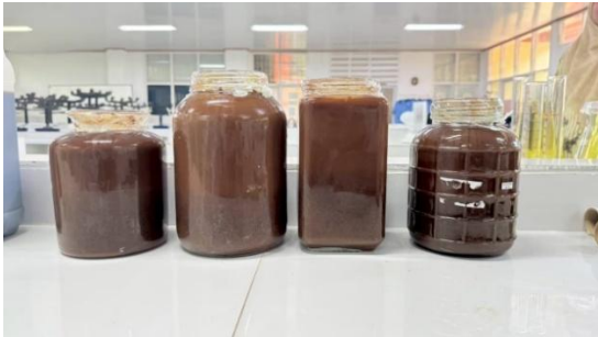
Gambar 3. Ekstraksi konvensional dengan metode maserasi (Dokumentasi pribadi,2025)
